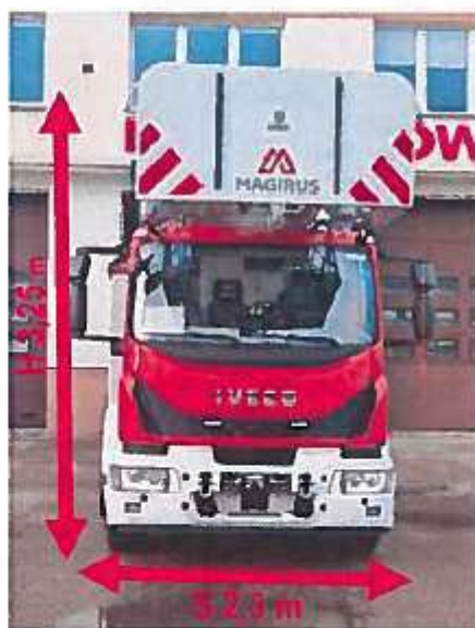
Rysunek 3. Wymiary samochodu typu SCD-42
